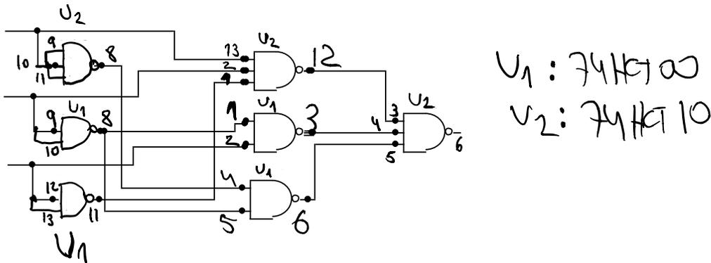
g) Quantos circuitos integrados da série 74XX seriam necessários para implementar os circuitos obtidos em e)?
