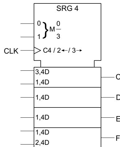
**10. [1.5 val]** A partir do circuito indicado, concretize um contador binário síncrono com uma entrada X que conte ciclicamente de forma decrescente entre 11 e 3 quando X=0, e entre 0 e 15 (ascendente) quando X=1. Justifique.
