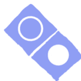
Figura 1: Qubit, em que a célula inferior está ativa (círculo branco) e a superior está no estado incerto (círculo não colorido).
