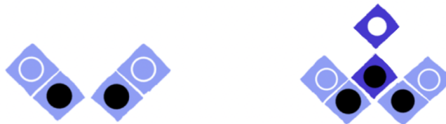
Figura 3: Um par de qubits (à esquerda); um par de qubits, aliados à representação da concordância das células inferiores e da discordância das células superiores (à direita).
